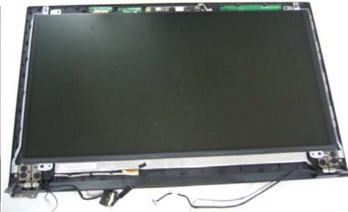
En la esquina inferior y superior de la Fig.13 hay algunos tornillos. Destornillarlos para separar la unidad LCD Fig. 15 y Fig. 16. El resultado se encuentra en la Fig17.
